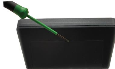
2. Die beiden Schrauben der Wandhalterung lösen
