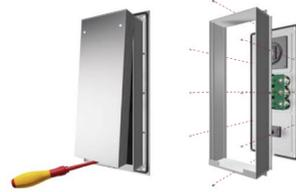
Ausgeliefert wird der Wandleser fertig montiert in einem Behnke-Serie 20 Modulrahmen. Wollen Sie den Leser in einen Mehrfachrahmen integrieren, lösen Sie die 3 Schrauben mit der die Spange am Modulrahmen befestigt ist. Sie können jetzt die Zentralscheibe mit den Leiterplatten abheben und in einen anderen Behnke-Serie 20 Rahmen einbauen.
