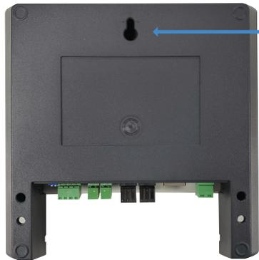
1. Für die Wandmontage bohren Sie zunächst ein kleines Loch in gewünschter Höhe zum Einhängen des TController vor.
