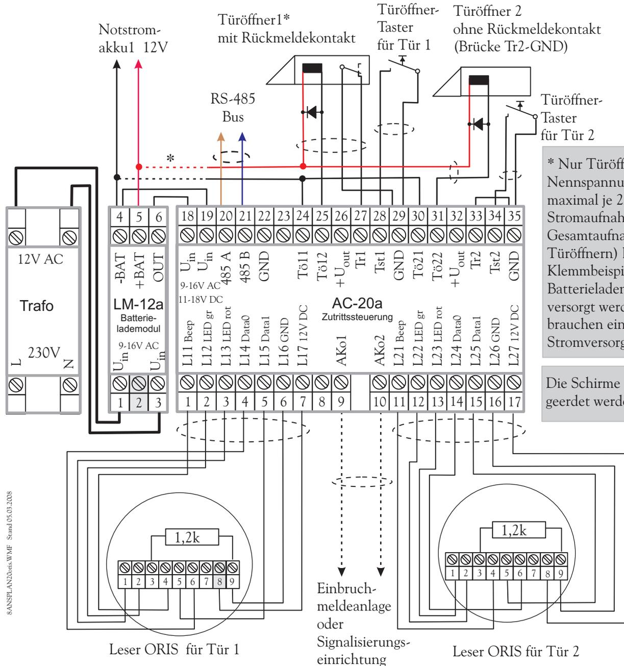
\* Nur Türöffner mit einer Nennspannung von 12 V DC und maximal je 250 mA Stromaufnahme (500 mA Gesamtaufnahme bei 2 Türöffnern) können, wie in diesem Klemmbeispiel zu sehen, über das Batterielademodul mit Strom versorgt werden. Alle anderen brauchen eine externe Stromversorgung.
